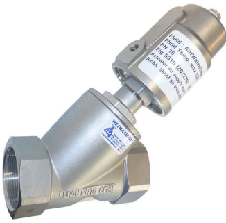
fig 531II klepafsluiter RVS pn16 pneum. enkelwerkend normaal gesloten 1/2" - 2" bsp huis en pneumaat : RVS 316 PTFE klepafdichting stuurdruk pneumaat : 3 - 10 bar temp. : -25°C/+180°C meestroomsluitende pneumaat fig 531II NPT : 1/2" - 2" npt
