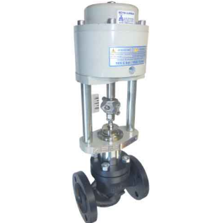
fig 535 klepafsluiter gietijzer PN16 DN 15 - DN100 huis : nodulair gietijzer GGG40 PTFE/grafiet parabolische zitting temp. : -10°C/+200°C - stoom tot 12 bar/192°C enkelwerkende pneumaat NC stuurdruk pneumaat : 6 - 10 bar
