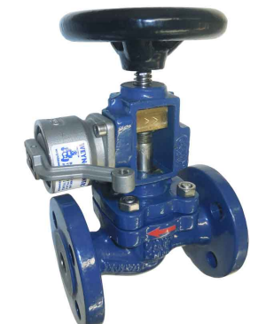
fig 440 snelsluit-klepafsluiter PN16 noodafsluiter DN 15 - DN 200 huis : nodulair gietijzer GGG40 RVS spindel, klep, balg en zitting temp. : -10°C/+350°C
