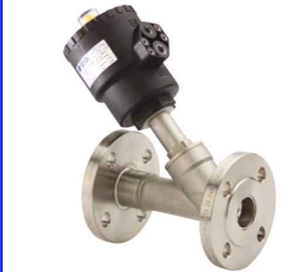
fig 537 klepafsluiter RVS pn16 geflensd pneum. enkelwerkend normaal gesloten DN 15 - DN 50 huis : RVS 316 / pneumaat : polyamide PTFE klepafdichting stuurdruk pneumaat : 3 - 8 bar temp. : -10°C/+180°C tegenstroomsluitende pneumaat
