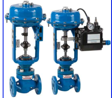
fig 532 pneumatische klepafsluiter PN16 DN 20 - DN 100 huis : gietijzer RVS binnenwerk temp. : -10°C/+250°C enkelwerkende pneumaat NC fig 532R : PN16 met positioner 4-20 mA fig 538 : met flenzen 150 lbs fig 538R : met flenzen 150 lbs en positioner
