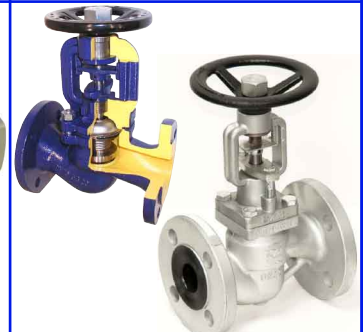
fig 473 balgafsluiter PN25/16 DN 15 - DN 200 huis : nodulair gietijzer GGG40 RVS spindel, klep, balg en zitting temp. : -10°C/+350°C - stoom max. 10 bar DN 15 - DN 50 : PN25 DN 65 - DN 200 : PN16
