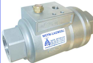
fig 530 klepafsluiter inox pn16 3/8" - 2" bsp pneum. enkelwerkend normaal gesloten RVS 304 huis EPDM afdichting NAMUR pneumatische aansluiting VDI/VE temp. : -20°C/+150°C stuurdruk pneumaat : 4 - 8 bar fig 530NPT 3/8" - 2" NPT
