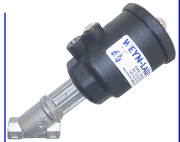
fig 531I klepafsluiter RVS pn16 pneum. enkelwerkend normaal gesloten 1/2" - 2" bsp huis : RVS 316 / pneumaat : polyamide PTFE klepafdichting stuurdruk pneumaat : 3 - 10 bar temp. : -25°C/+180°C meestroomsluitende pneumaat
