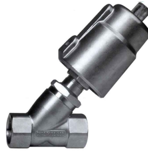
fig 536II klepafsluiter RVS pn16 pneum. enkelwerkend normaal gesloten 1/2" - 2" bsp huis en pneumaat : RVS 316 PTFE klepafdichting stuurdruk pneumaat : 3 - 10 bar temp. : -25°C/+180°C tegenstroomsluitende pneumaat
