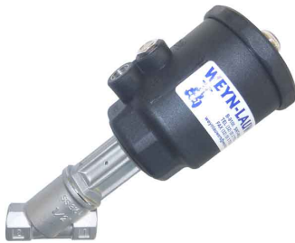
fig 531II klepafsluiter RVS pn16 pneum. enkelwerkend normaal gesloten 1/2" - 2" bsp huis en pneumaat : RVS 316 PTFE klepafdichting stuurdruk pneumaat : 3 - 10 bar temp. : -25°C/+180°C meestroomsluitende pneumaat fig 531II NPT : 1/2" - 2" npt
