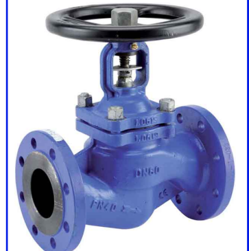
fig 485 balgafsluiter PN40 DN 15 - DN 200 huis : staal A216/CWB RVS spindel, klep, balg en zitting temp. : -20°C/+400°C
